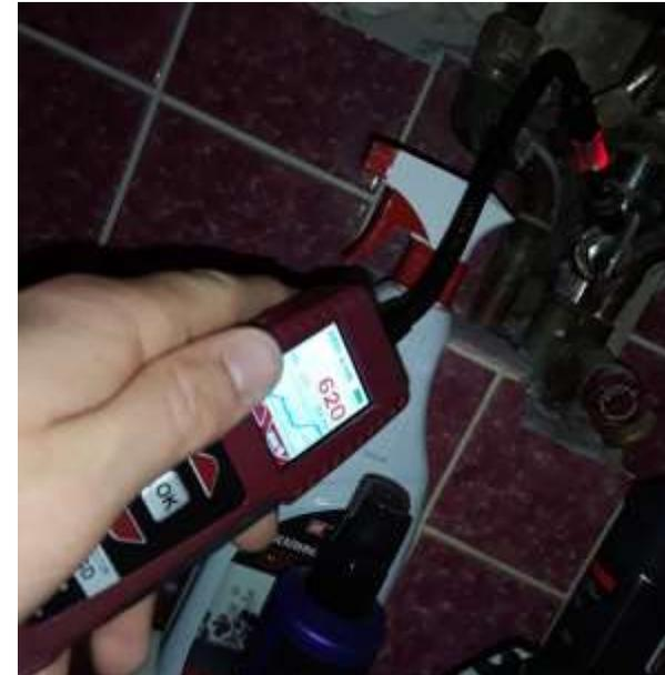
Gerätesperrung mit rotem Aufkleber und Sperrbanderole aufgrund von CO im Abgas > 1000 ppm
